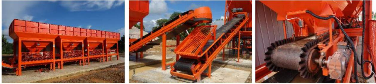
Ленточный конвейер с боковой стенкой/Сигнал при нехватке материалов/
